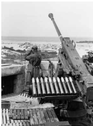
6. ábra: 5 cm Flak 41 tüzelőállásban. Látható a töltőtálcára helyezett 2 darab 5 töltényes töltőkeret 5
