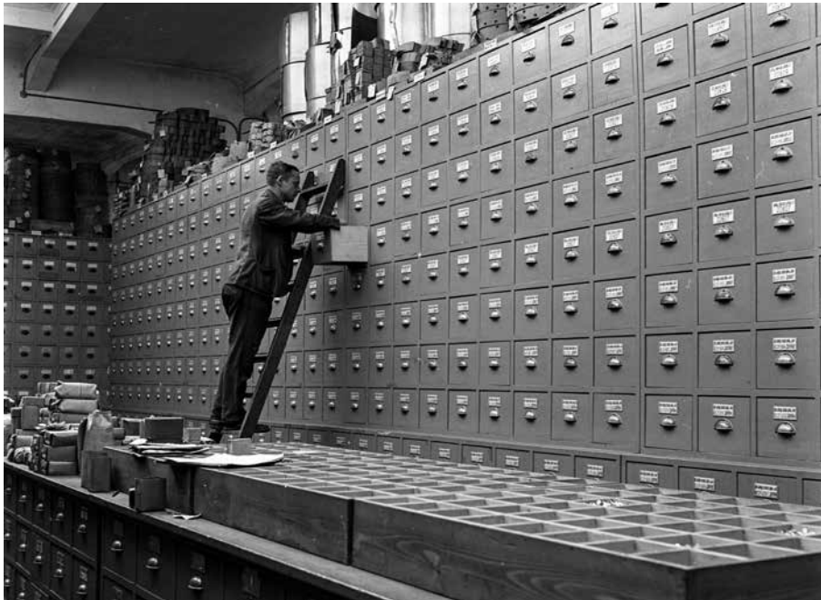
Csavartároló szekrény, a szerelvények egyedi kódjaival a fiókokon, illetve egy rekeszes nagy fiók az asztalon, amelybe az egyes javítandó gépkocsikhoz szükséges kisebb alkatrészeket gyűjtötték össze egy előre meghatározott lista szerint (FORTEPAN 72505, Lissák Tivadar)
